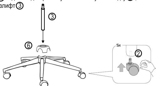
3. В лучи пятилучья ⑨ установите ролики ②, на центральную часть пятилучья ① наденьте декоративную пластиковую накладку ⑥, вставьте газлифт ③
