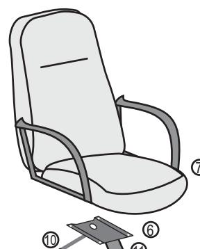
6. Сидение установите отверстием в металлической площадке на газпатрон.
