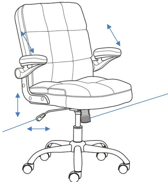
Винт регулировки жесткости качания кресла в зависимости от веса пользователя (находится под сиденьем спереди). Если крутить в сторону «-»/loose – качаться будет легче, если крутить в сторону «+»/tight – качаться будет тяжелее
