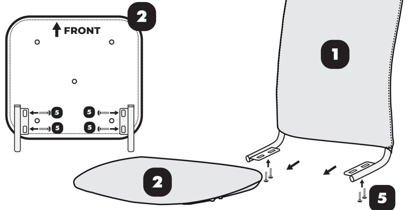
**II** Отвёрткой Ph3 наживите винты M6x30 **8** на посадочные места деталей - № I, II, III, IV.
